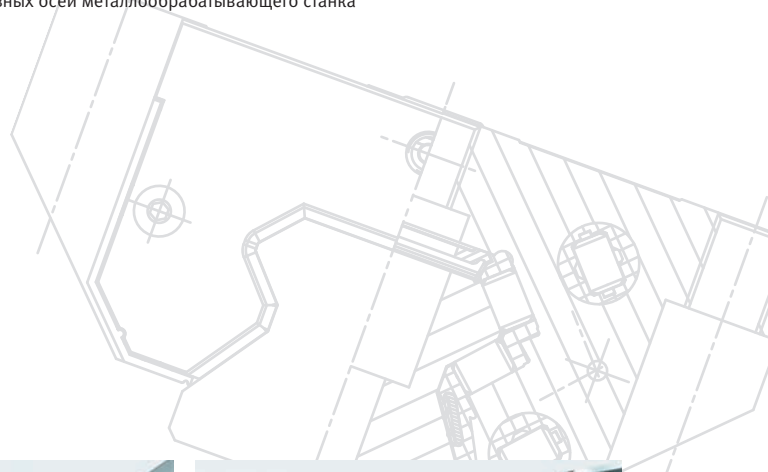
Роликовые линейные направляющие RUE..E – надежные опоры для главных осей металлообрабатывающего станка
