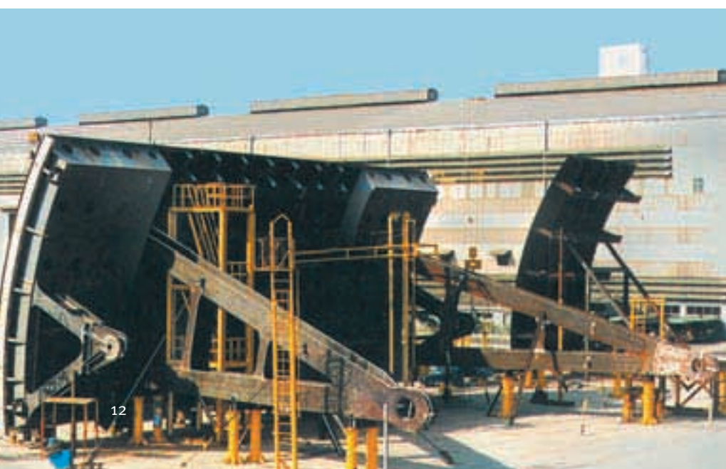
Гигантские размеры: сегментные щиты на дамбе «Сай-ман-гум» имеют высоту 15 метров и ширину 30 метров
