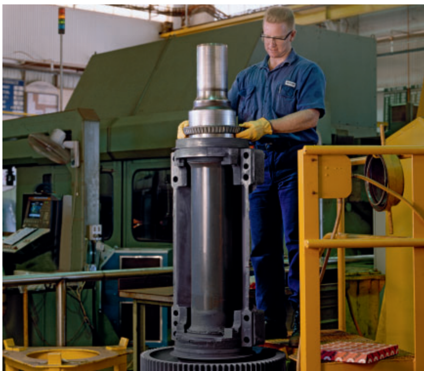
Монтаж моторноосевых подшипников
