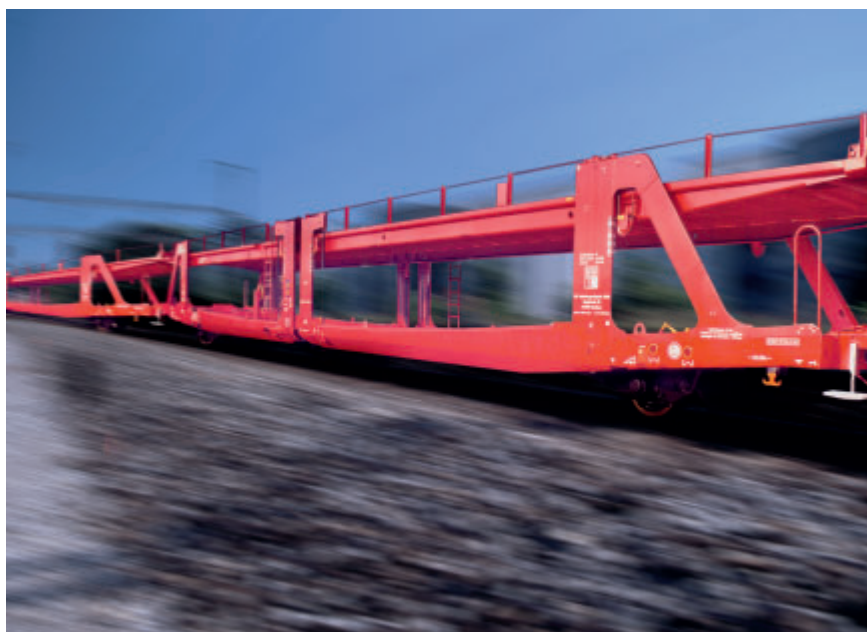
Двухэтажный вагон для перевозки автомобилей Laes 559, Tatravagónka a.s
