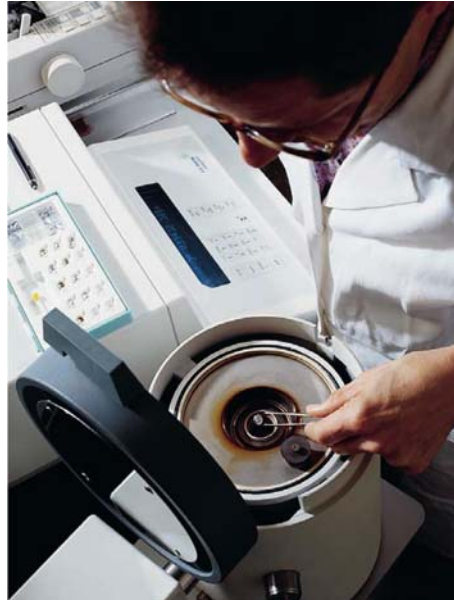
Основательная проверка материала керамического шарика для гибридных подшипников качения в исследовательском центре FAG.
