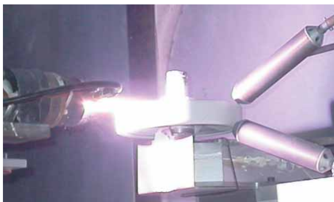
5. Метод плазменного напыления
